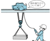
床上操作式クレーン
