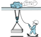
床上操作式クレーン
