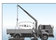
小型移動式クレーン
