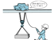
床上操作式クレーン
